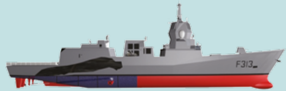
Figura 13 – Alagamento dos compartimentos da fragata
