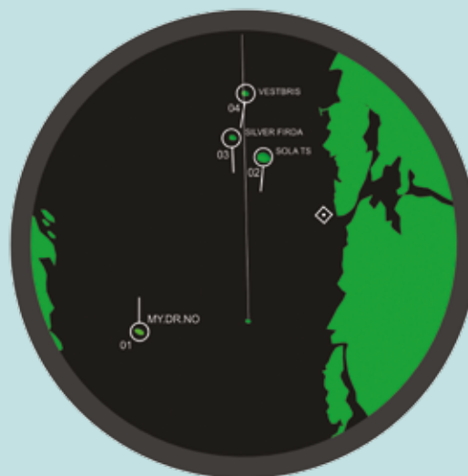
Figura 5 – Tela do radar com ARPA, integrada ao AIS
